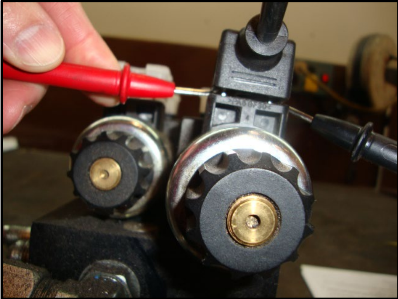
Fig. 8-4 Checking Din Plug Voltage
