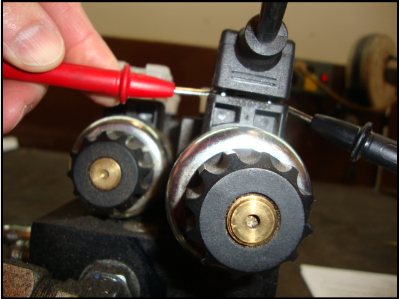
Fig. 8-4 Checking Din Plug Voltage
