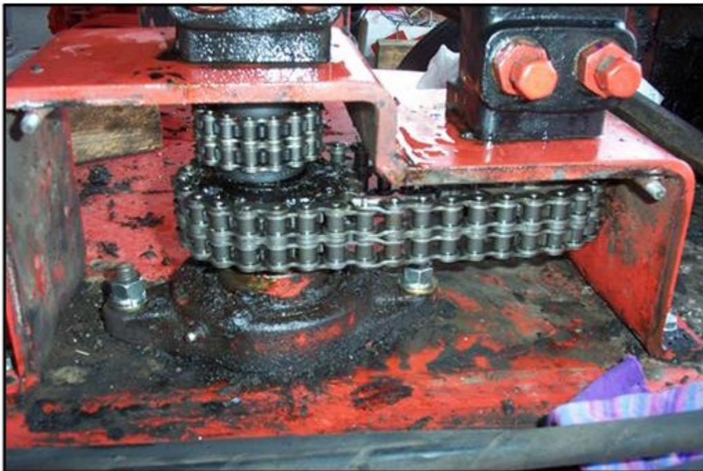
Figura 6-15 Pasos para apretar la Cadena del Agitador
