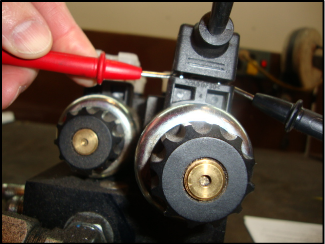
Figura 8-4 Verificar el Voltaje del Conector Din
