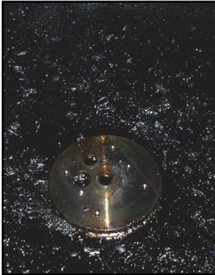
Figura 6-8 Limpieza de la Placa de Montaje de la Bomba
