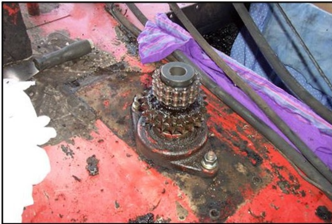
Figura 6-12 Colocación del Eje de la Bomba
