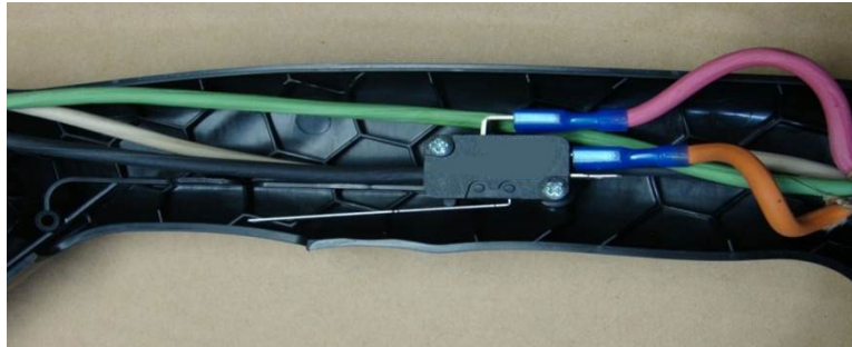
Figura 6-16 Ubicación del Cable del Interruptor
