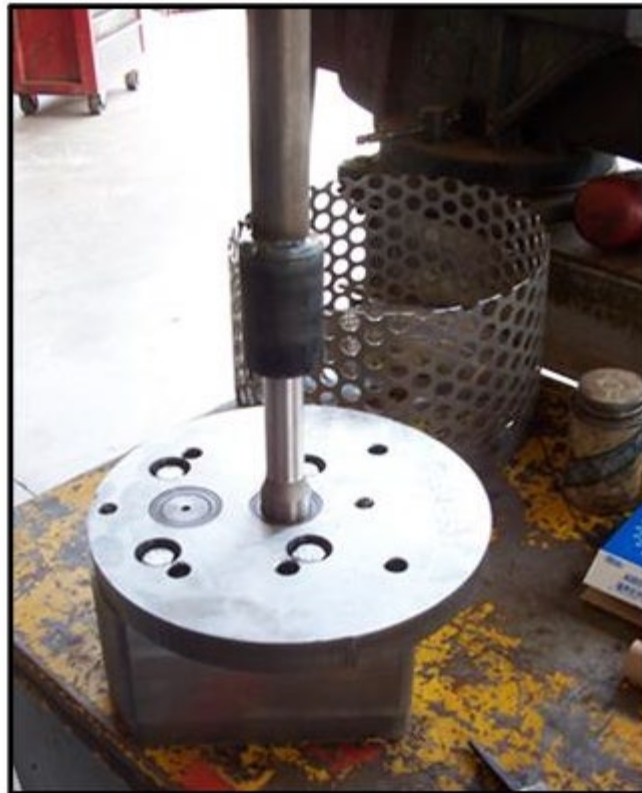
Figura 6-9 Eje de Transmisión de la Bomba Encajando en la Bomba de Material
