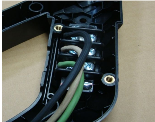
Figura 6-18 Cableado de la Caja de Terminales
