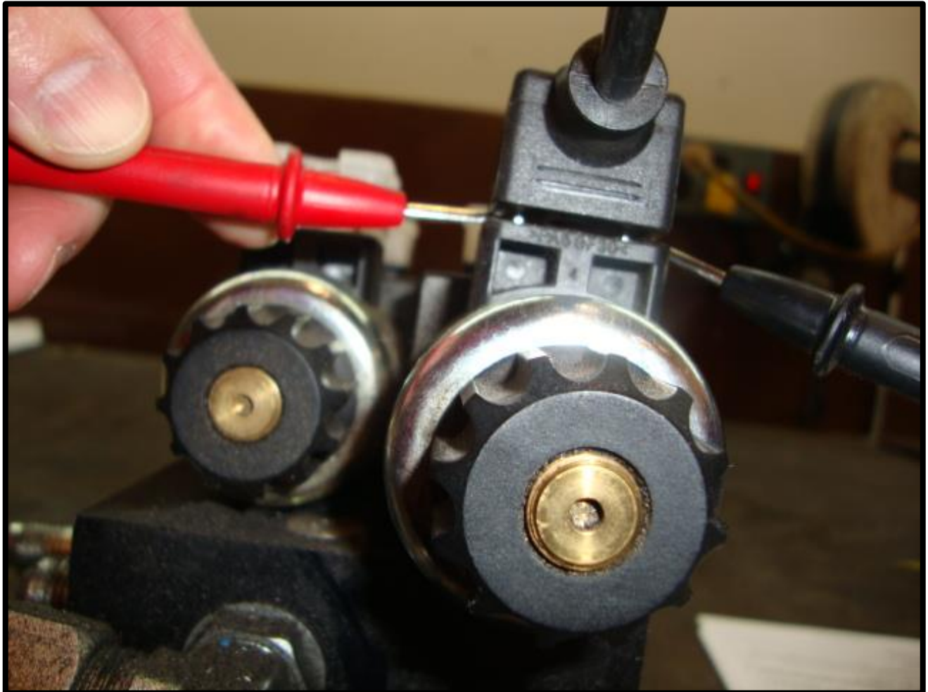
Fig. 8-4 Checking Din Plug Voltage
